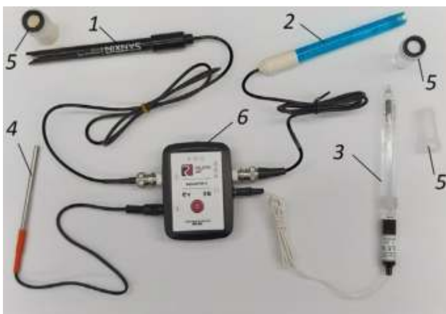
Рис. 4. Снаряжённый мультидатчик по экологии: 1 — щуп датчика электропроводности, 2 — щуп датчика pH , 3 — электрод сравнения, 4 — щуп датчика температуры, 5 — защитные колпачки (сняты)
