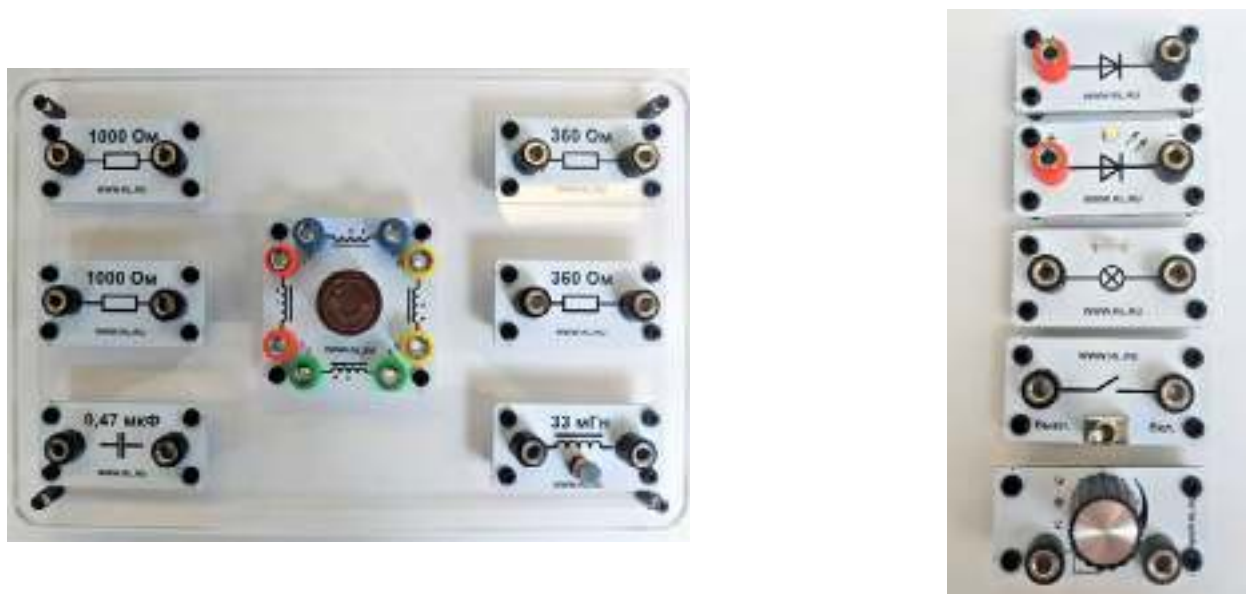
Рис. 17. Дополнительные элементы электрических цепей
